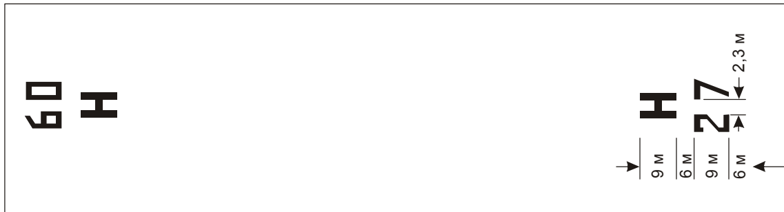
Рис. 5-2. Маркировка обозначения зоны FATO и вертодромная опознавательная маркировка для зоны FATO типа ВПП
