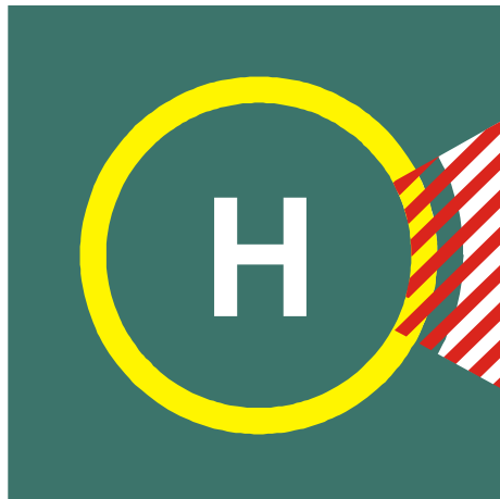
Рис. 5-7. Маркировка запрещенного для посадки сектора вертопалубы
